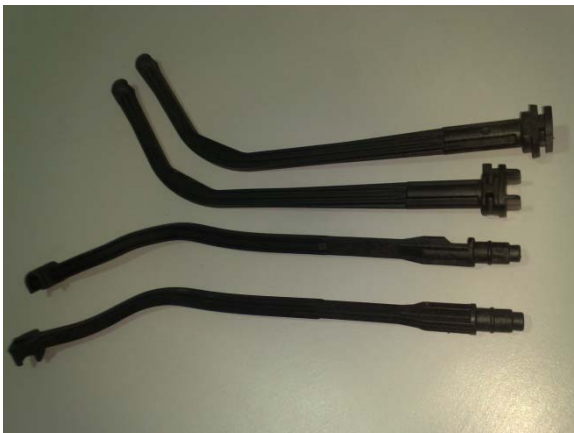
Inyección de varillas de accionamiento en PA 6.6 + 30 % fv.
