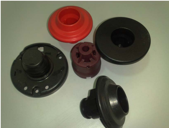
Inyección en POM rojo y negro y PA 6.6 +30% fv granate.
