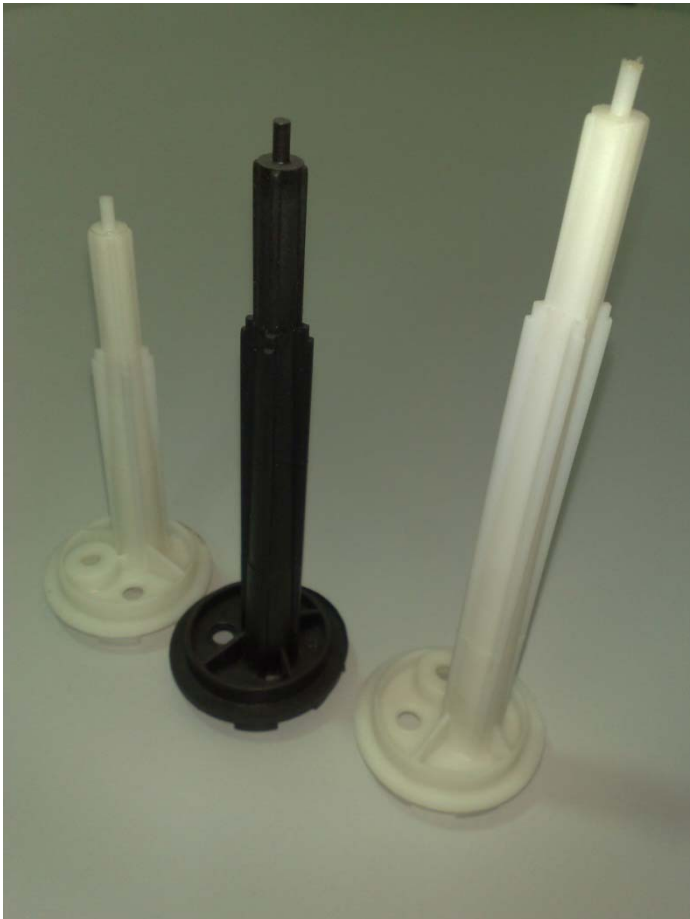
Inyección vertical de boyas en PP + 20%fv.
