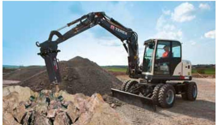
Solución de demolición potente con la posibilidad de manejar martillos hidráulicos, pulverizadores de hormigón y pinzas de clasificación.
