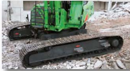
Unterwagen - großes Abstützquadrat für hohe Standfestigkeit Undercarriage - large outrigger area for maximum stability
