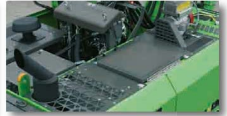
Sicherer Zugang zum Oberwagen, rutschfeste Tritt- und Arbeitsflächen Safe access to the upper carriage with anti-slip footbars and work spaces
