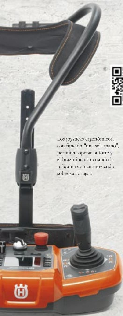
Los joysticks ergonómicos, con función “una sola mano”, permiten operar la torre y el brazo incluso cuando la máquina está en movimiento sobre sus orugas.
