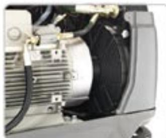
Ventilador eléctrico para máxima refrigeración.
