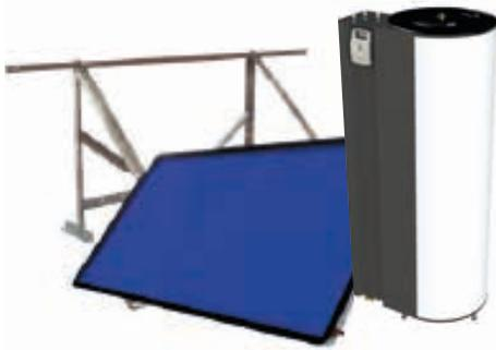
El Sistema solar drainback DRH Premium, está formado por captadores solares de alto rendimiento modelo DRH Premium 22 o 26 y un interacumulador AX 150-500, construido en acero INOX AISI-444 con soldadura a testa indicado para climas tropicales y con un serpentín de intercambio térmico para ACS totalmente extraíble y fabricado en acero INOX AISI-316L.
