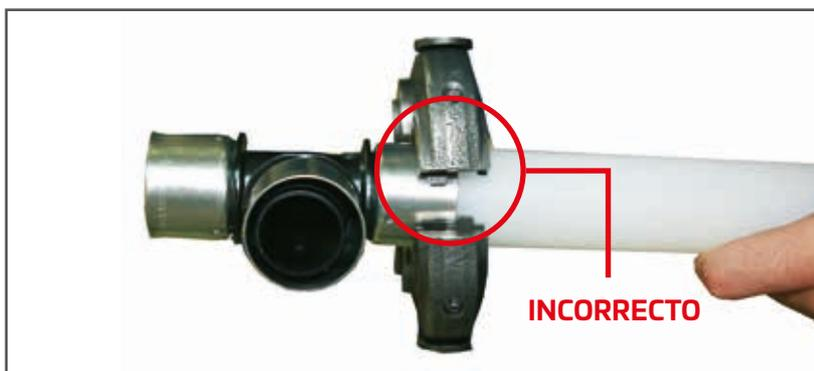
**5.** Insertar la cuna adecuada al diámetro exterior del tubo que se está conectando. Colocar la boca de la prensa centrada en el casquillo, pegando a la balona (No presar nunca fuera del casquillo).
