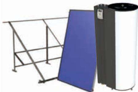
El Sistema solar drainback DRV slim, está formado por captadores solares de alto rendimiento modelo DRV SLIM 20 o 25 y un interacumulador AX 150-500, construido en acero INOX AISI-444 con soldadura a testa indicado para climas tropicales y con un serpentín de intercambio térmico para ACS totalmente extraíble y fabricado en acero INOX AISI-316L.
