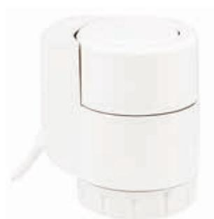
Cabezal termoeléctrico para montaje sobre válvula de corte en colector, funcionamiento a 230 Vca; normalmente cerrado. Puede incluir microrruptor auxiliar (opción 4 hilos) que indica la posición del cabezal correspondiente a la apertura total de la válvula. Puede emplearse, por ejemplo, para validar el arranque de una bomba. *Montaje directo sobre colector mediante adaptador M30x1,5 incluido.*
