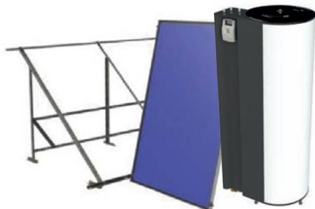
El Sistema solar drainback CSV slim, está formado por captadores solares de alto rendimiento modelo CSV SLIM 20 o 25 y un interacumulador AX 150-500, construido en acero INOX AISI-444 con soldadura a testa indicado para climas tropicales y con un serpentín de intercambio térmico para ACS totalmente extraíble y fabricado en acero INOX AISI-316L.
