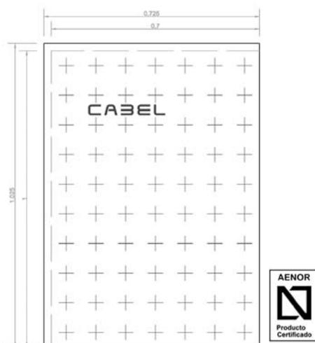
Panel aislante CABEL liso, fabricado en poliestireno expandido (EPS) o poliestireno expandido con grafito (EPS + grafito), autoextinguible (Euroclase E) de 25mm de espesor, densidad de 20 kg/m<sup>3</sup>, cubierto por una lámina superficial de polietileno tereftalato (PET), de 0,25mm de espesor, provisto de solapas para unión entre paneles y cuadrícula de guía serigrafiada.
