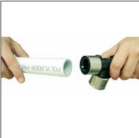
**3.** Colocar el casquillo sobre el tubo, hasta el final y después introducir la boquilla del accesorio. De esta forma puede observarse si pellizca la junta en la ejecución.
