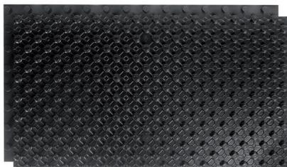
Panel aislante con tetones, en poliestireno expandido, autoextinguible (clase E), de 10, 18, 20, 25 y 40 mm de espesor útil; provisto de tetones moldeados para la fijación del tubo con separaciones en múltiplos de 50 mm, y perfiles perimetrales machihembrados para el montaje; con lámina de poliestireno termoformado, color negro, de 600 µm de espesor.
