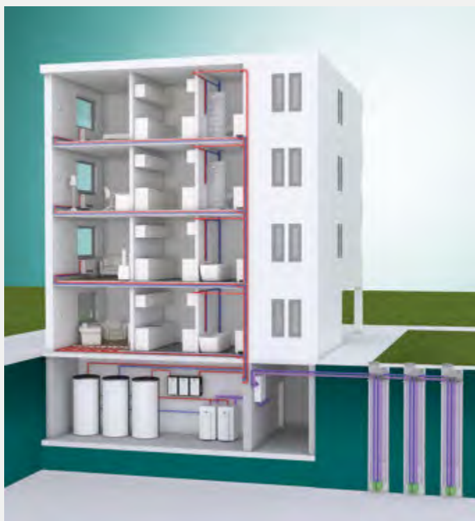
Combinación recomendada para servicio ACS Sistema de acumulación allSTOR y módulo de ACS aguaFLOW exclusive
