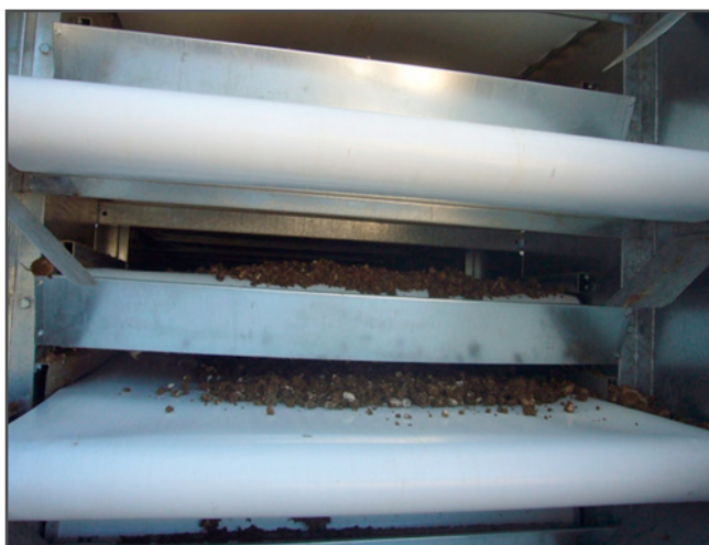
Banda transportadora de PP para gallinaza . Se sirve en rollos, anchos y longitudes según cliente.
