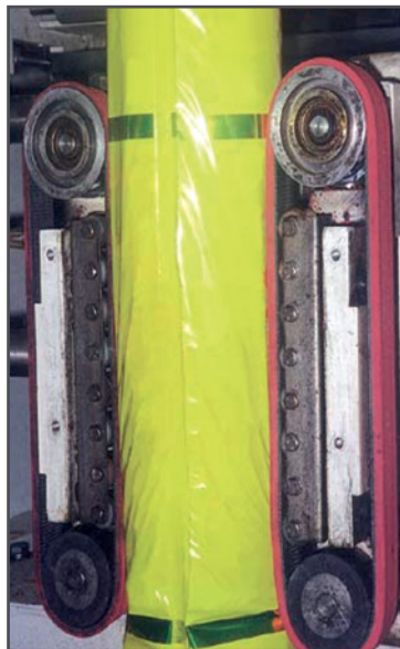
Correas dentadas con recubrimiento para embolsadoras verticales .
