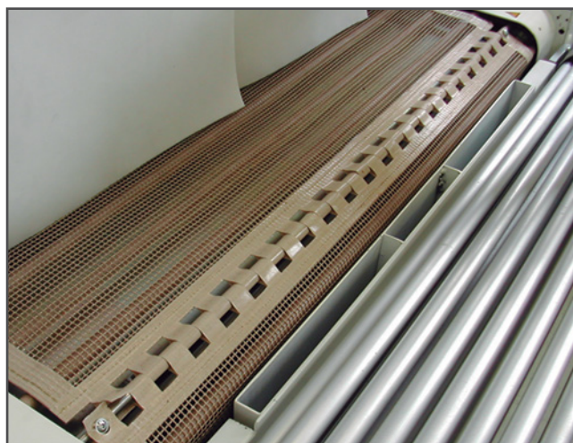
Mallas de tejido de vidrio o aramida con recubrimiento de teflón con diferentes aperturas de malla.
