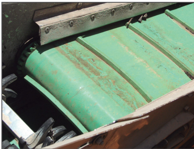
Bandas especiales para la vendimia , con tacos, guías internas y también aletas.
