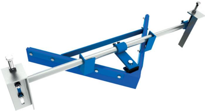
Rascador interno con cuerpo en acero galvanizado, láminas de Poliuretano en forma de V y tensores laterales. Se instala en la zona de retorno para proteger el tambor de cola.
