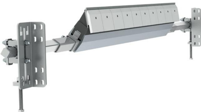
Rascador secundario con cuerpo en acero galvanizado, láminas rascadoras segmentadas con tungsteno de 3mm, pletinas de PE anti-apelmazantes y bloques amortiguadores de caucho. Es un rascador muy eficiente por su capacidad de adaptación a la banda. A partir de ancho 1.400mm se recomienda el modelo reforzado.
