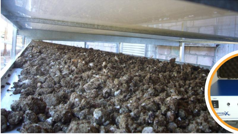
Banda transportadora extrusionada de polipropileno blanco para la recogida de gallinaza, con aditivo UV. Se fabrican a medida, ancho y largo a determinar por el cliente.
