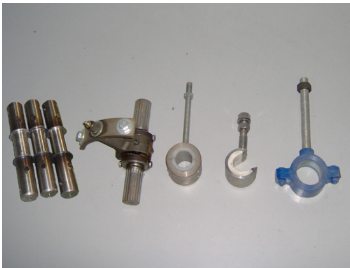
Diferentes tipos de soportes intermedios, péndulos con casquillos de bronce, delrin, etc. con sus ejes intermedios
