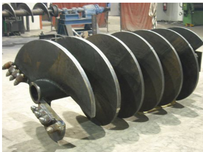
Barrenas para perforación en acero, al carbono St- 52 con dientes para túneles y pivotes
