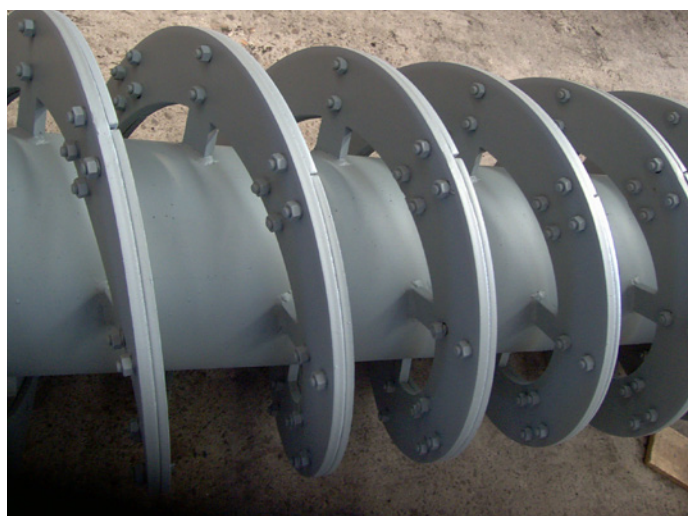
Espiras reforzadas, atornilladas en acero antidesgaste de fácil recambio.
