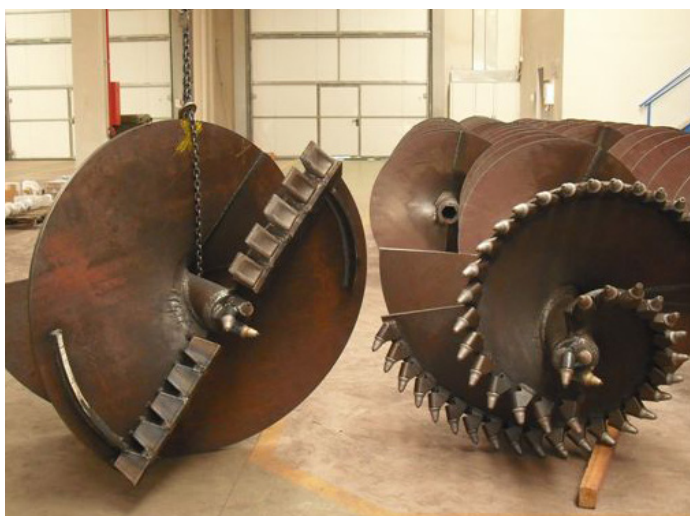
Barrenas para perforación en acero, al carbono St- 52 con dientes para túneles y pivotes
