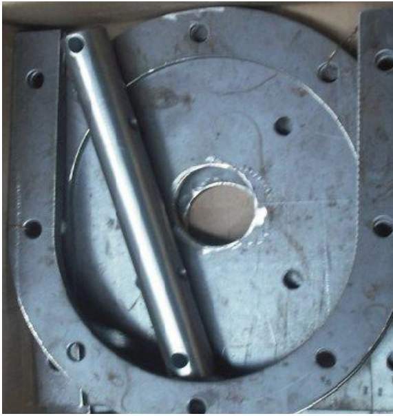
“U”, testeros y ejes de empalme sueltos fabricados en acero al carbono y acero inoxidable.
