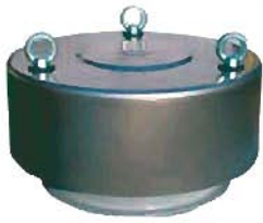
Válvula presión/depresión Protege la estructura del silo de sobrepresiones y depresiones. Tara de presión 0 y 400 mm c.a
