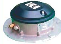
Presostato mecánico Tiene por objeto informar de sobrepresiones durante el cargamento neumático del silo. Tarado a 400 mm c.a.
