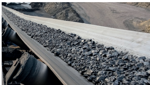
Aplicación I Banda transportadora con material altamente abrasivo.
