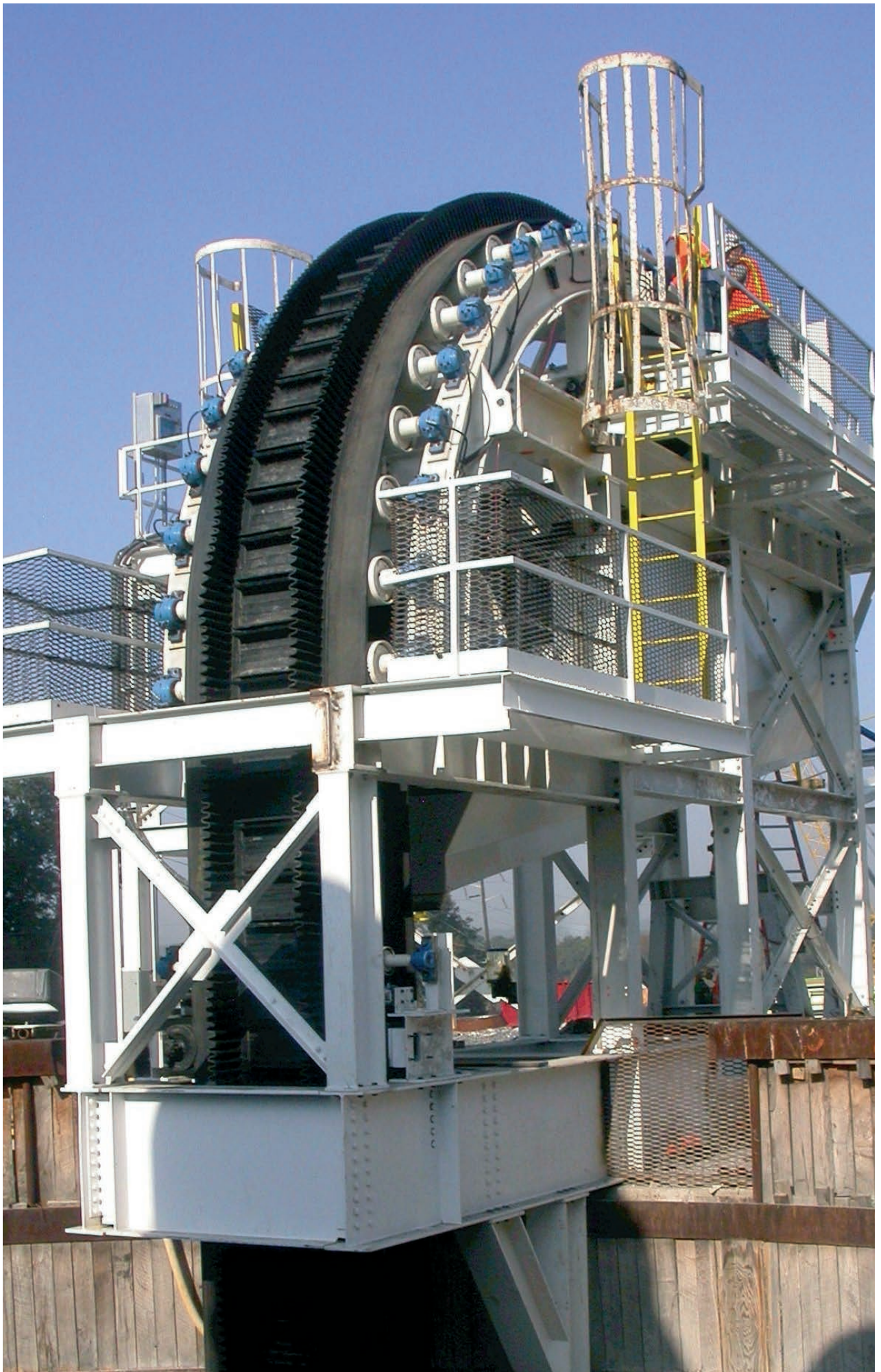
Aplicación I Bandabord para la elevación de producto.
