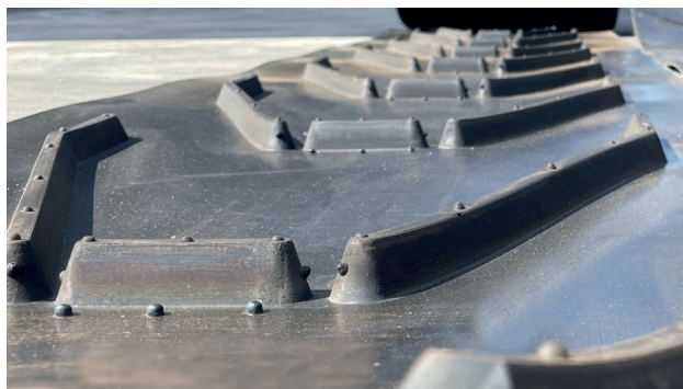
Banda chevron I Con perfiles de 25 mm de altura.
