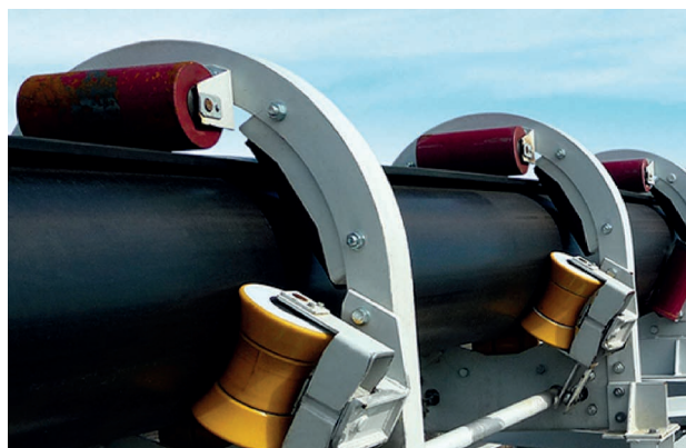
Banda PIPE | Sistema de transporte con un diseño cerrado.
