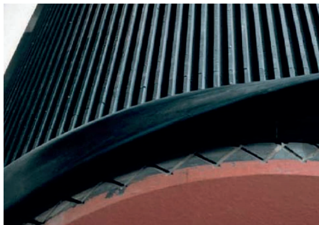
Banda filtrante | Diseño con ranuras que permiten el filtraje.
