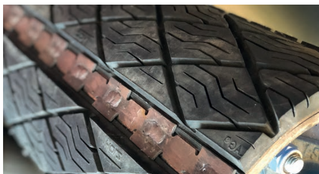
Slide-lag I Módulos de caucho fijados mediante guía doble.
