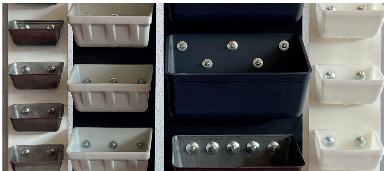
Banda elevadora | Distintos modelos de banda, con diferentes anchos y cangilones de varios materiales.
