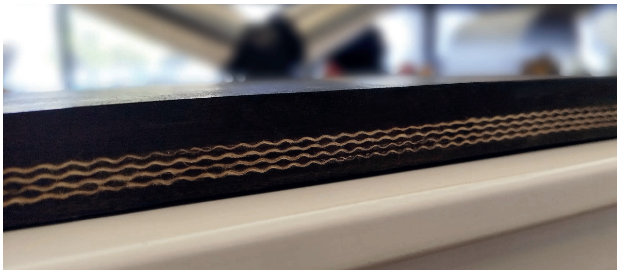
Banda de carcasa textil I Telas y caucho.
