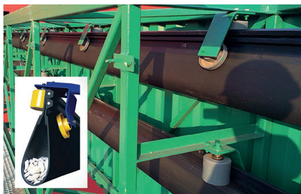
Banda SICON | Compuesta por una bolsa de caucho flexible.
