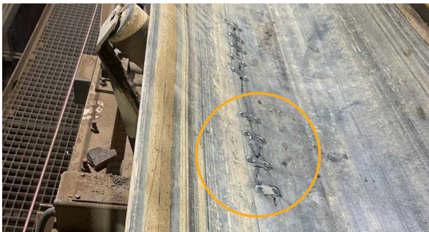
Desgarro longitudinal detectado y evitado gracias a SHG Rip Prevent+.
