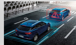
Aviso peligro colisión frontal.
